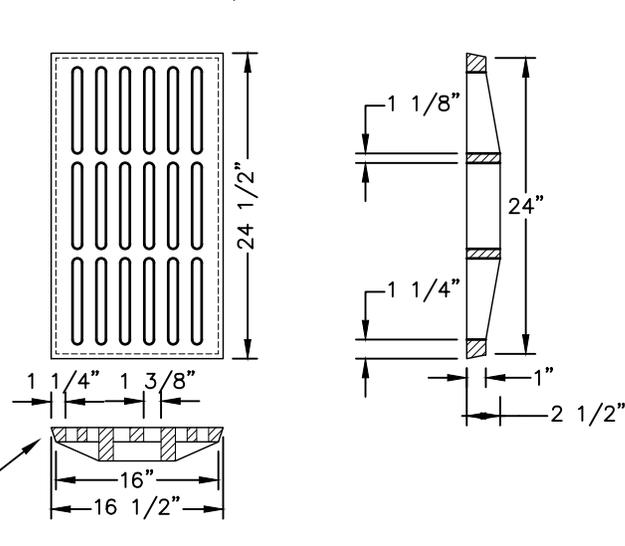
**CAST IRON / CAST STEEL GRATE FRAMES**
