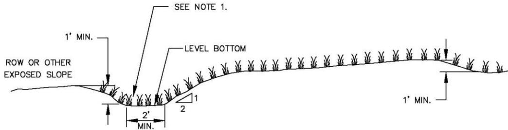
BOTTOM WIDTH - 2 FEET MINIMUM; THE BOTTOM WIDTH SHALL BE LEVEL.
